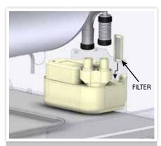
FIGURE 24. CONDENSE PUMP REMOVAL
