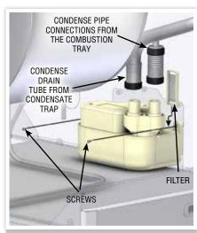
FIGURE 27. CONDENSE PUMP REMOVAL
