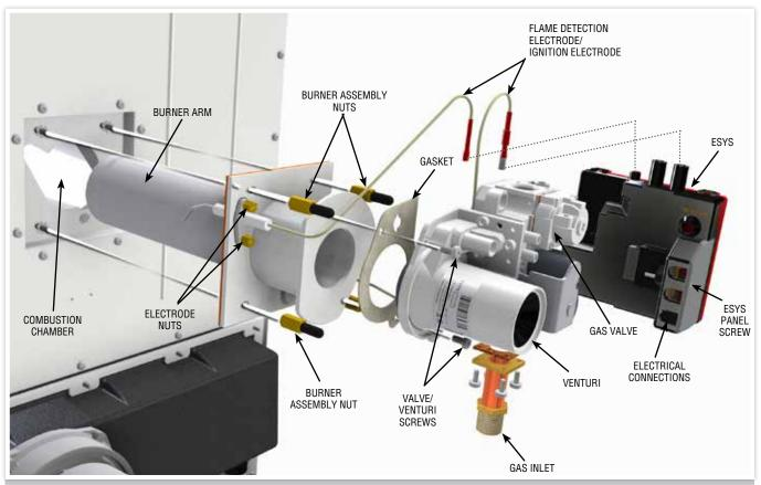
FIGURE 28. MAIN BURNER ASSEMBLY
