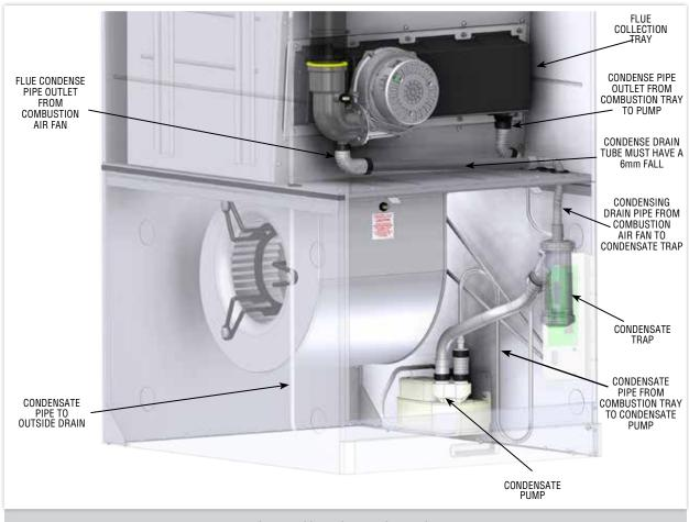
FIGURE 23. CONDENSE PIPEWORK LAYOUT
